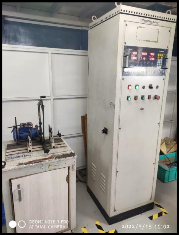
Blower Fan Balancing
